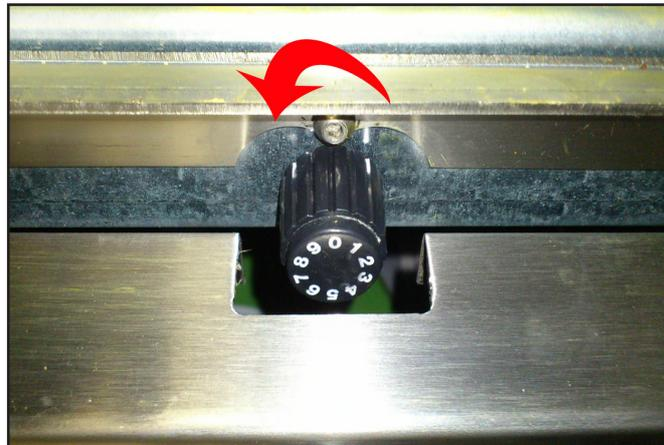
Der Drehknopf unterhalb des Aschekastens ist verbunden mit dem Automatikregler. Bei diesem Regler handelt es sich um eine Grundeinstellung und soll im Anheiz- und Weiterheizbetrieb in Normalstellung = 1 - 4 gedreht sein.
