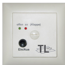
Netzteil mit Elektronik in 8X8 cm Dose, Kontroll LED-Anzeigen
